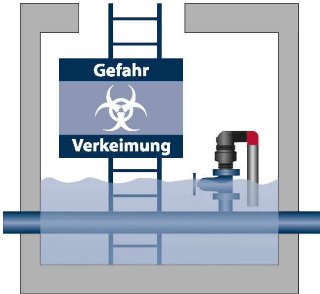
Verkeimungsgefahr durch Einsaugen von Brackwasser.
